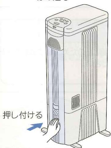
化粧パネルの「上」と表示してある方を上方向にして、パネルの下側に差し込み、全体を押し付けます。つめが「パチッ」と音がするまで押し付けてください。
